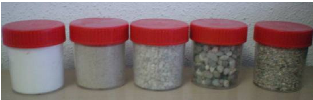
Granulats utilisés dans le béton polymère
